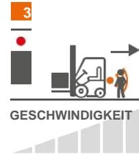
Bei über 1,5 m breiten Fahrzeugen heißt die aktive Assistenzlösung **Safe&Stop+**: ein Antikollisionssystem mit zwei untereinander synchronisierten Ultraschallsensoren, die ein größeres Gebiet überwachen. Die Vorrichtung weist den Fahrer auf die Gefahr hin, wobei es das Fahrzeug bei einem bevorstehenden Aufprall verlangsamt\* und stoppt\*.
