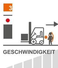
Wenn **Safe&Stop** durch den Ultraschallsensor auf der Rückseite des Fahrzeugs ein Hindernis im Aktionsbereich erkennt, wird der Bediener sofort mit Leucht- und Tonsignalen darauf hingewiesen. Zudem wird das automatische Bremssystem bis zum Fahrzeugstillstand\* aktiviert, wodurch das Kollisionsrisiko auf ein Minimum reduziert wird.
